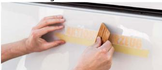
Richten Sie die Schriftzeilen an den gezogenen Hilfslinien (Krepp-Band) aus und fixeren Sie die Beschriftung leicht an der Fahrzeugoberfläche. Rakeln Sie nun die Schriftzeilen aus der Mitte heraus, in überlappenend Zügen an.
