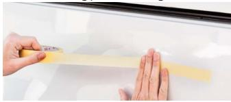
Ziehen Sie sich mit Krepp-Band Hilfslinien, an denen die Schriftzeilen ausgerichtet werden.
